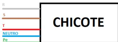
Se o forno for trifásico 380 V deve ser utilizado um disjuntor trifásico. Conecte os fios da seguinte forma: os 3 fases no disjuntor, o fio neutro diretamente na rede e o fio terra diretamente ao aterramento da rede (caso não o tenha, providenciar conforme NBR 5410).
