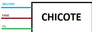
Se o forno for monofásico 220 V deve ser utilizado um disjuntor bifásico. Conecte os fios da seguinte forma: Fase e neutro no disjuntor e o fio terra diretamente ao aterramento da rede (caso não o tenha, providenciar conforme NBR 5410).
