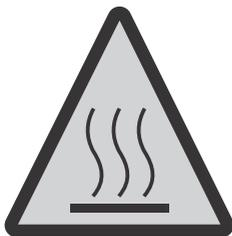
Tenha cuidado ao entrar em contato com as partes externas do forno, pois a sua superfície irá aquecer durante o funcionamento. Observe o adesivo que sinaliza o cuidado ao tocar nas partes quentes do equipamento.
