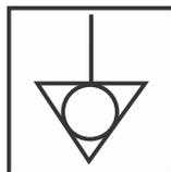
O símbolo ao lado indica o terminal de ligação equipotencial, destinado à ligação do equipamento via condutor elétrico a outros pontos de ligação equipotencial, tais como equipamentos, bancadas, edificações, mantendo-se deste forma o equilíbrio entre diferentes pontos de ligação, minimizando possíveis riscos de choque elétrico. Este terminal permite a conexão de um cabo de seção nominal de 10mm<sup>2</sup>.
