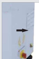
Tampa na lateral, para acessar o sistema
