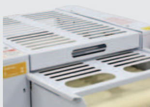
Proteção móvel intertravada com parada imediata
