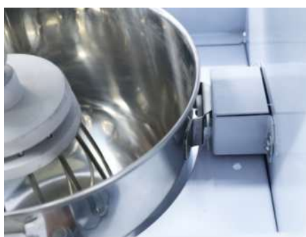
SENSOR MAGNÉTICO QUE SOMENTE HABILITARÁ O FUNCIONAMENTO DA MÁQUINA COM O MESMO NA POSIÇÃO DE TRABALHO.
