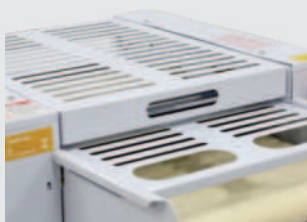
Proteção móvel intertravada com parada imediata
