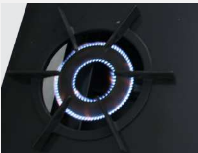
QUEIMADOR CHAMA DUPLA TRASEIRO Chama dupla com Ø 150mm, com consumo de 0,321kg/h e potência de 3.659 kcal/h
