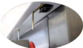
Dispositivo que desliga a turbina quando abre a porta, nos modelos de 8 e 10 esteiras.
