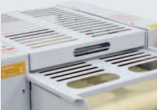
Proteção móvel intertravada com parada imediata
