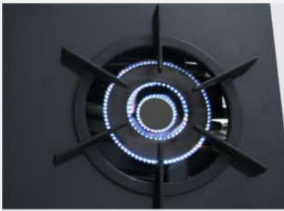
QUEIMADOR CHAMA TRIPLA FRONTAL Chama interna com Ø 50mm e com consumo de 0,066kg/h Chama dupla externa com Ø 150mm e com consumo de 0,292kg/h e potência total de 4.082 kcal/h
